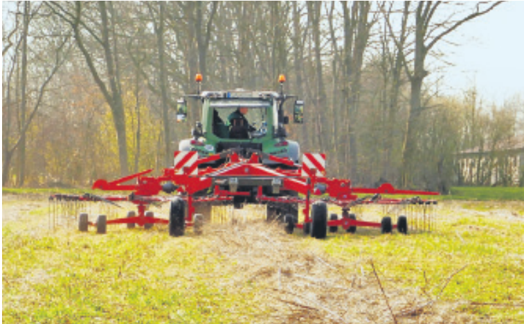
Um die Effektivität zu erhöhen, kann auch ein Schwader eingesetzt werden, um die Stängel zu bergeln.
