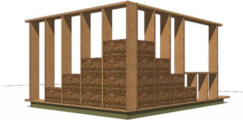
Lastragende Bauweise (links) und Holzständerkonstruktion (rechts). Quelle: D. Scharmer / FASBA
