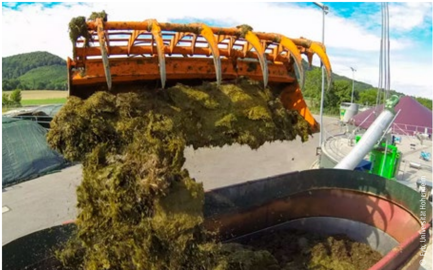
Feststoffdosierer an der Forschungsbiogasanlage „Unterer Lindenhof“.
