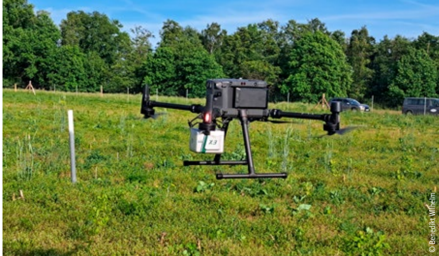
Einsatz einer Drohne mit Laserscanner
