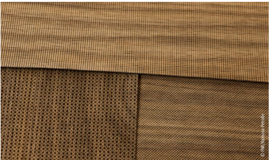
NUO Holztextil ist eine vegane Ledervariante, die aus Echtholz furnier in Verbindung mit einem Textilträger hergestellt wird
