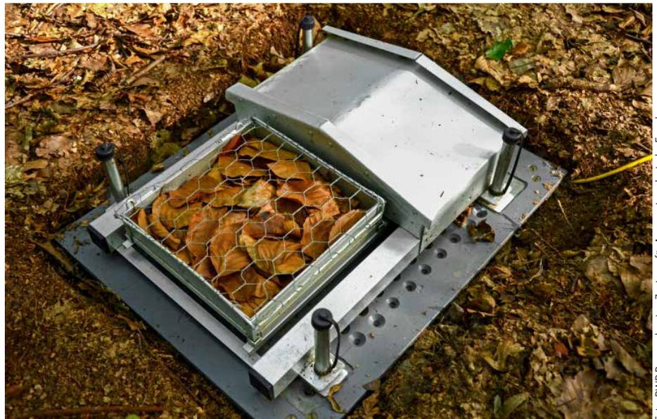
**Abb. 1:** Zur kontinuierlichen Messung der Streufeuchte wurde am DWD-Forschungsstandort Braunschweig eine im Projekt WBI-Praxis entwickelte Streuwaage platziert.
